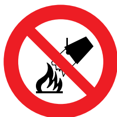
VIETATO SPEGNERE CON ACQUA
